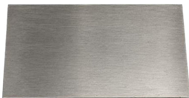
Gambar 2 Lempeng baja karbon ringan berukuran 5x3x0,01 cm
