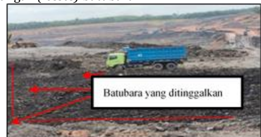
Gambar 8 Batubara Tertinggal di Area Side-Wall pada Front Penambangan
