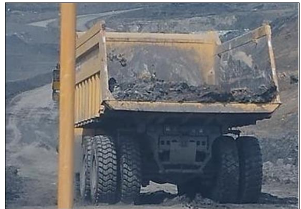
Gambar 5 Sisa Material Overburden yang Masih Tertinggal pada Vessel
