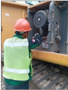
Gambar 2 Pemeriksaan kondisi baterai
