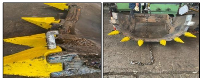
Gambar 7 Pemasangan Lockpin dan raberlockpin
