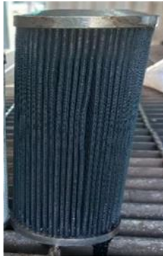
Gambar 1 High Pressure Filter yang terkontaminasi Sumber : Dokumen Pribadi
