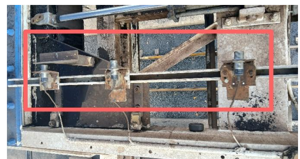
Gambar 7 Silinder 2 dengan 3 sensor proximity
