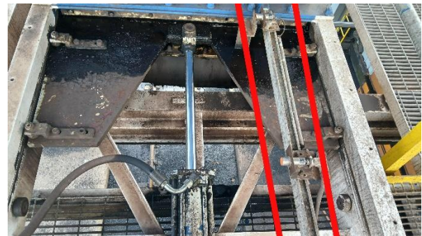
Gambar 6 Silinder 1 dengan 2 sensor proximity
